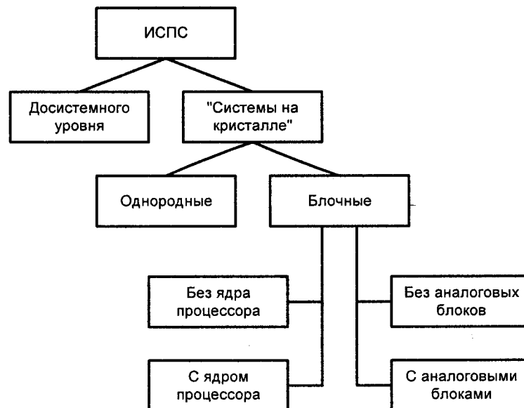
Рис. 3. Классификация ПЛИС по уровню интеграции
