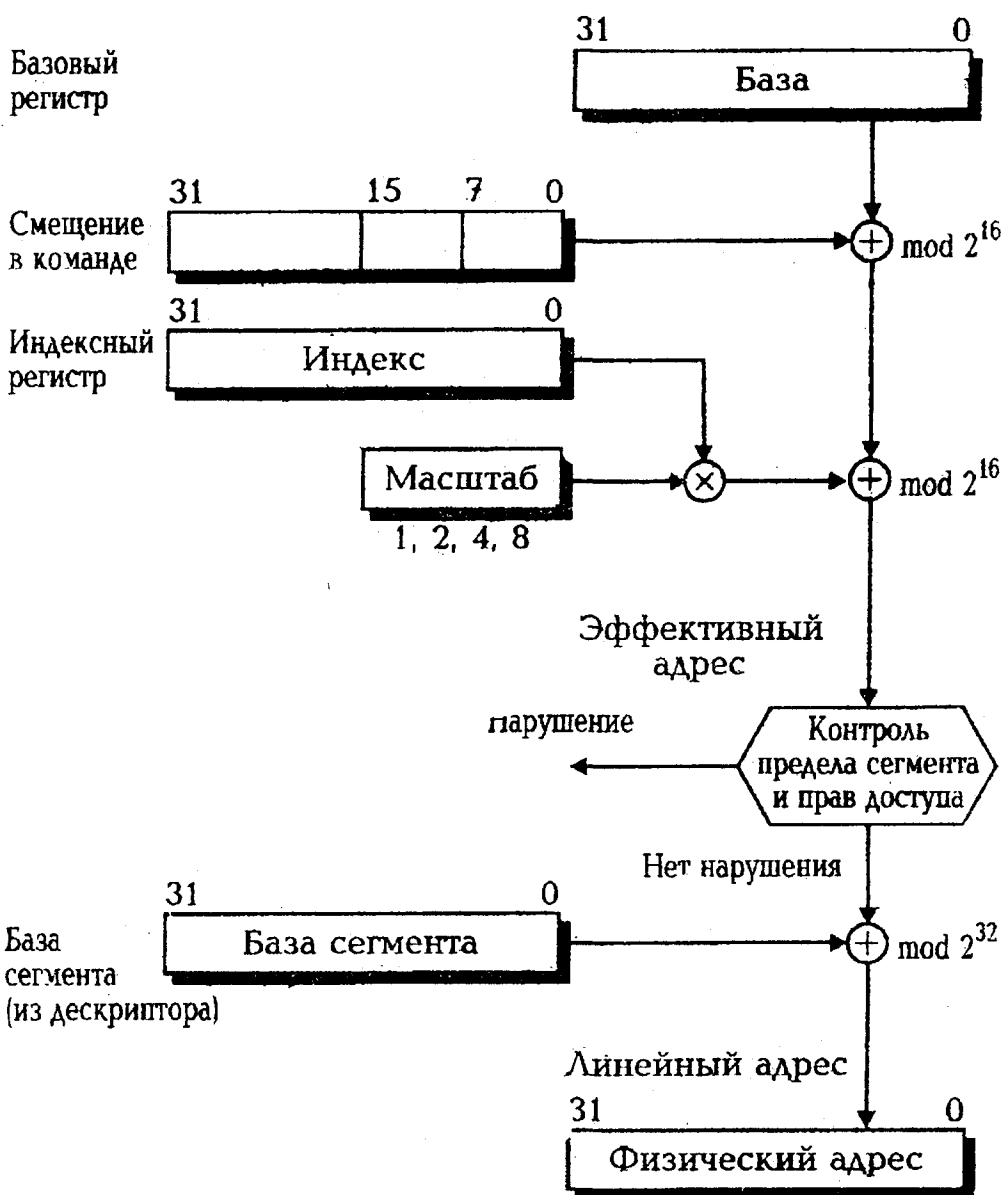
Процесс формирования адреса в 32-битной адресации
